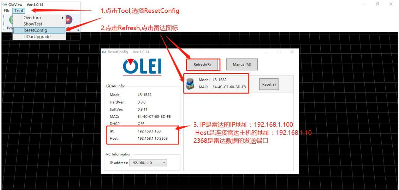
2. 选择雷达型号，填写雷达 IP 和端口号
