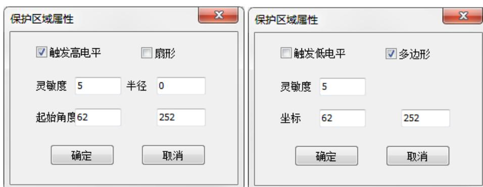
在编辑模式下可以通过输入具体坐标值来微调坐标点的位置，也可以设置该区域在触发状态下输出的电平模式（闯入区域保护区域则输出高电平或设置成输出低电平），还可以选择保护区域是多边形或扇形。灵敏度是指在区域保护内触发点的个数的阈值，例如区域保护 1 的灵敏度是 5，那么当区域保护 1 中只有 4 个点时该区域不会触发输出电平变化。被选中的区域保护会变成蓝色线条，点的坐标会随之显示。全部设置完成后点击单个保存或者全部保存再点击运行，激光雷达按照新设定的区域开始工作。
