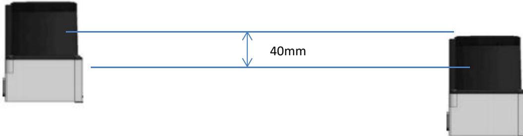
由于传感器光斑锥形发散状发射, 建议激光扫描传感器安装离地高度  $\geq 200\text{mm}$ , 若安装离地高度  $< 200\text{mm}$  时, 请将 激光扫描传感器向上倾斜  $1\sim 3^\circ$
