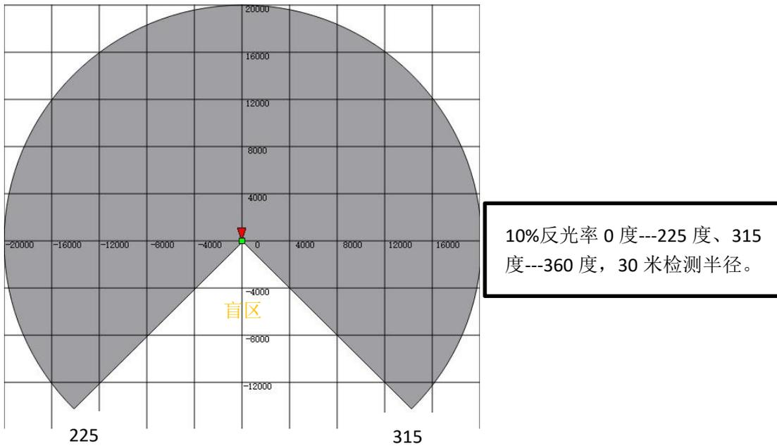
检测物体大小激光扫描传感器中有一个旋转镜，激光光束脉冲会随这旋转镜不停的以 0.25 度转角发射，从而可以扫描一个扇形的区域。发射出的激光光束会覆盖一个扇形面，从而可在最大 270°的区域内识别物体。
