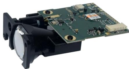
SK100 采用激光相位法测距原理。可以通过激光的发射和接收，非接触方式测量到自然目标之间的距离值。
