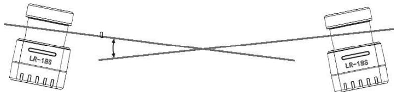
图 30 激光雷达横向放置
